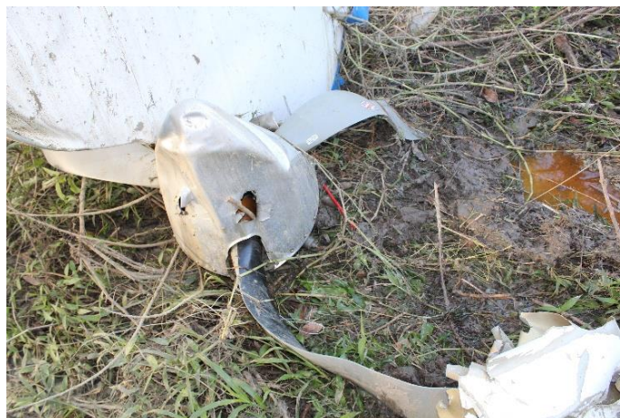
Fig. 2 – Imagen de la hélice con el daño en las palas
