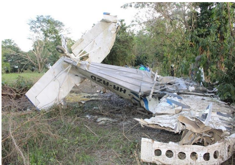
Fig.1- Imagen de daños en el fuselaje de la aeronave.
